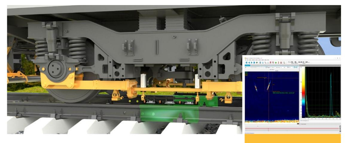
Система подачи контактирующей жидкости обеспечивает бесперебойную подачу воды в том числе с подогревом, для проведения контроля даже в условиях низких температур.
